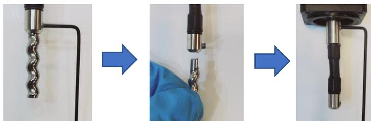
13. 卸下轴封块，检查轴封。如有磨损，请更换轴封。
