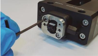
2. 使用 8 mm (5/16") 扳手或月牙扳手拆卸压力传感器，或使用平头螺丝刀拆卸歧管堵头。如有损坏，请更换堵头螺丝的 O 型圈。
