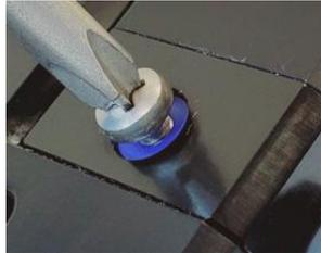
**警告：**请勿转动超过 8 整圈。否则会使螺丝松动，使加压的物料喷出。
