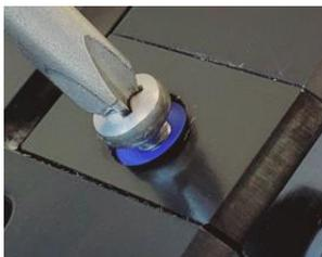
**警告：**不要松开超过 8 整圈。否则会使螺丝松动，使加压的物料喷出。
