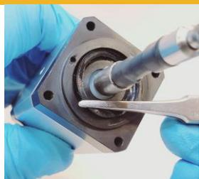
11. 使用 1.3 mm 内六角扳手卸下转子固定螺丝。
