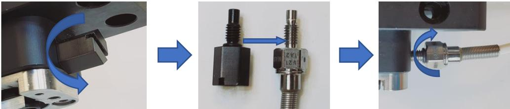
**提示：**要避免电缆“卷曲”，请在将传感器紧固在泵上之后才将传感器安装到控制器上。
