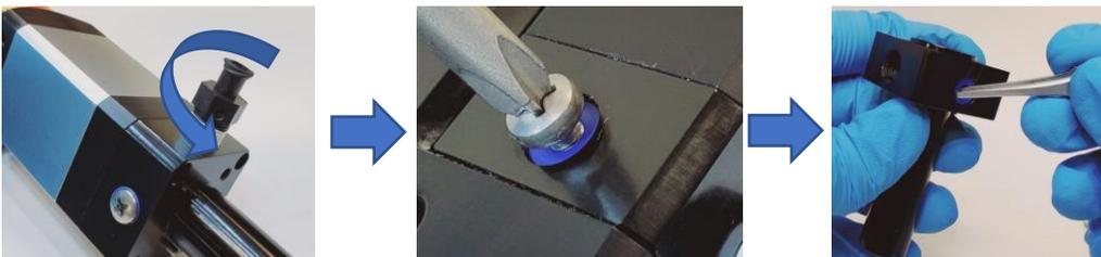
5. 使用 3.0 mm 内六角扳手卸下四颗 (4) 六角螺丝。分开流体歧管、泵壳体和泵组件。
