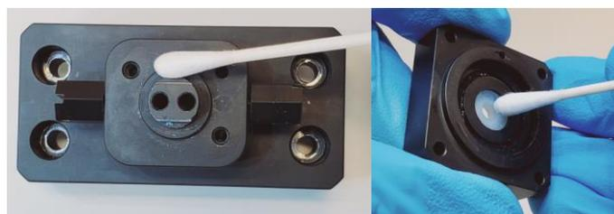
6. 使用小刷子清洁歧管的流体路径通道、流体开口、放气螺丝开口、校准适配器和其他喷嘴适配器开口。
